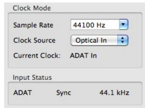
Das erstmalig in der RME Hammerfall eingesetzte Verfahren **SyncCheck** dient der einfachen Prüfung und Anzeige der aktuellen Clock-Situation. Die mit Input Status beschriftete Statusbox zeigt für die Eingänge ADAT, AES und Word Clock getrennt an, ob kein Signal (No Lock), ein gültiges Signal (Lock), oder ob ein gültiges *und* synchrones Signal anliegt (Sync). Im Feld *Clock Mode* wird angezeigt zu welchem Signal die Synchronität besteht (siehe auch Kapitel 37.1).
