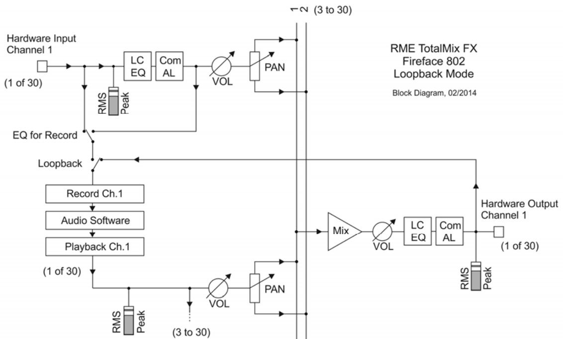
Das Blockschaftbild zeigt, wie das Eingangssignal der Software über Playback ausgegeben, und von dort über den Hardware Output zurück zum Softwareeingang gelangt.
