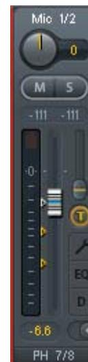
Da sich bei aktiviertem Trim-Knopf die Gains aller Routings eines Kanals gleichzeitig ändern, bewirkt dieser Modus im Grunde das gleiche wie ein Trim-Poti im Eingangskanal, der das Signal schon vor dem Mischpult reduziert oder verstärkt. Daher die Namensgebung dieser Funktion.
