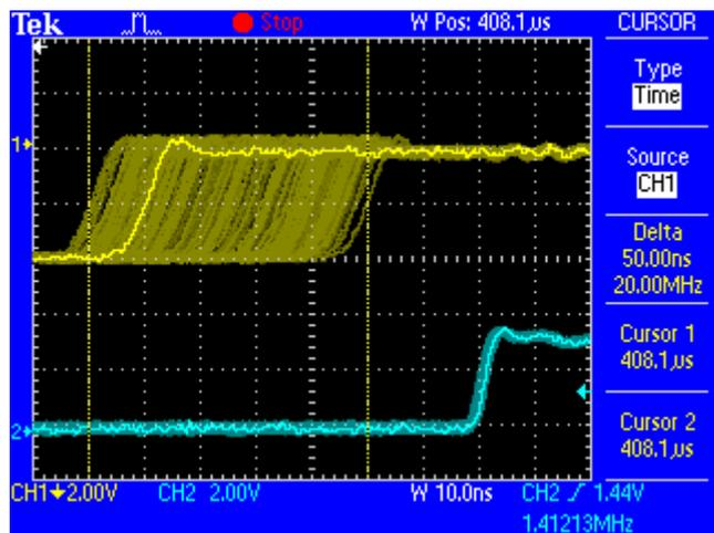
Der Screenshot zeigt ein mit circa 50 ns extrem verzerrtes SPDIF-Signal (obere Linie, gelb). Dank SteadyClock wird daraus eine Clock mit weniger als 2 ns Jitter (untere Linie, Blau). Das von SteadyClock prozessierte Signal wird natürlich nicht nur intern benutzt, sondern dient auch zur Taktung der digitalen Ausgänge. Daher kann das gesäuberte und von Jitter befreite Signal bedenkenlos als Referenz-Clock benutzt werden.
