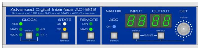
In der **MATRIX** erfolgt die Kanaluweisung aller Eingänge und Ausgänge. Auto Delay Compensation (**ADC**) verhindert Offsets bei Verwendung mehrerer ADI-642.
