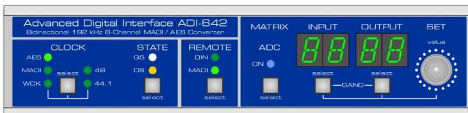
Der ADI-642 lässt sich per MIDI fernsteuern. Mit dem Taster REMOTE wird ausgewählt, von wo die MIDI-Befehle empfangen werden sollen, und an welchen Ausgang das Gerät Antworten sendet. Zur Auswahl stehen die MIDI-Buchsen und der MADI Ein- und Ausgang.
