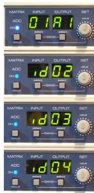
Bei aktiviertem Auto Channel Assignment ist die Kanaluweisung fest vorgegeben und nicht veränderbar. Die Tasten INPUT, OUPUT und SET sind daher an allen ADC Slaves gesperrt. Die Kanäle sind wie folgt zugewiesen:
