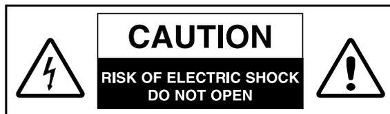
Wo immer auch dieses Symbol auftaucht, es erinnert Sie daran dass sich im Inneren eine nicht isolierte gefährliche Hochspannung befindet – eine Spannung die ausreichend stark genug ist, um einen Stromschlag zu verursachen.
