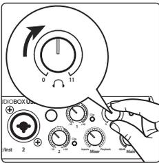
8. Schließen Sie einen Kopfhörer am Kopfhörerausgang der AudioBox USB96 an und bringen Sie den Regler für die Kopfhörerlautstärke in die mittlere Position (12 Uhr).
