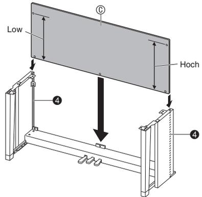
4. Befestigen Sie die linke Seite der Rücktafel ③ am Halter ⑤ von Seitentafel ① und die rechte Seite an Seitentafel ②. Ziehen Sie die beiden Schrauben ⑥ provisorisch an, um die Rücktafel vorübergehend zu fixieren.
