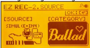
Drehe am Datenrad, bis z.B. "SIMUL (E+Mic)" im Display steht, der E-Gitarreneingang und die internen Mikros sind simultan aktiviert. Jetzt einmal auf den Pfeiltaster nach rechts tippen (neben dem Datenrad), und als Kategorie z.B. "BALLAD" einstellen, ENTER. Der BR-800 hat jetzt einen passenden Gitarrensound und ein passendes Drumpattern für Dich ausgewählt. Drücke nochmal ENTER, und Dein neuer Song wird erzeugt. Drücke REC und dann PLAY, und spiele und singe
