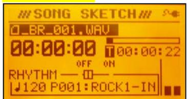
Einfach REC drücken, und der BR-800 nimmt über die beiden eingebauten Kondensator-Mikrofone in Stereo auf. Eventuell mit dem REC LEVEL-Regler noch aussteuern, die Anzeigebalken sind rechts im Display zu sehen. Nach dem Drücken des STOP-Tasters wird die Aufnahme im "wav"-Format gespeichert und ist durchnummeriert im Display zu sehen (schwarz hinterlegt). Hast Du mehrere wav-Dateien, kannst Du sie mit dem Datenrad auswählen, zum Abspielen drücke PLAY.
