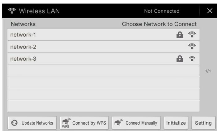
**HINWEIS** Wenn kein Signal von einem Zugangsknoten empfangen wird, kann dieser nicht aufgelistet werden. Geschlossene Zugangspunkte können ebenfalls nicht aufgeführt werden.
