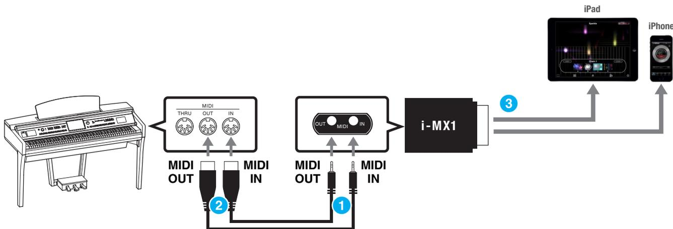
Achten Sie bitte darauf, den Anschluss MIDI OUT am i-MX1 mit dem Anschluss MIDI IN am Instrument und den Anschluss MIDI IN am i-MX1 mit dem Anschluss MIDI OUT am Instrument zu verbinden.
