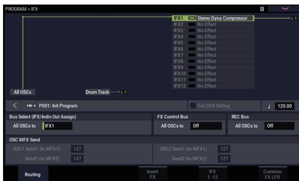
2. Geben Sie unter „Bus Select (IFX/Indiv. Out Assign)“ den Bus, an den der Oszillator angelegt werden soll. Um einen Oszillator mit Insert-Effekt 1 zu verbinden, müssen Sie „IFX1“ wählen.
