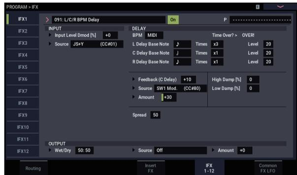
Wenn Sie den Joystick nach vorne schieben und gleichzeitig die SW1-Taste drücken, steigt der „Rückkopplungspegel“, so dass das Delay länger erklingt. Mit „Amount“ wählen Sie den Rückkopplungspegel, der bei Drücken der SW1-Taste aktiviert wird. Wenn Sie „Amount“ auf „–10“ stellen und die SW1-Taste drücken, beträgt der Rückkopplungspegel „0“.
