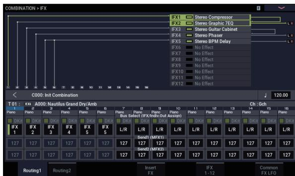
2. Wählen Sie mit „**Bus Select (IFX/Indiv.Out Assign)**“ den Bus, an den die Timbres angelegt werden sollen. Um ein Timbre mit Insert-Effekt 1 zu bearbeiten, müssen Sie hier z.B. „IFX1“ wählen.
