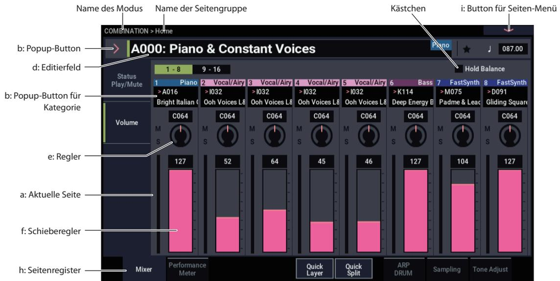
Der NAUTILUS enthält das grafikfähige und druckempfindliche „TouchView“-Display von Korg. Indem Sie die im Display angezeigten Elemente antippen, können Sie Display-Seiten aufrufen, Parameterwerte einstellen, Text eingeben, virtuelle Patch-Verbindungen herstellen usw.
