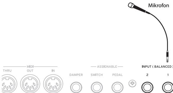
2. Wählen Sie im Dialog „Analog Input Setup“ (SHIFT- und AUDIO IN-Tasten) die Position „MIC“ und regeln Sie „Analog Input Gain“ auf einen Mittelwert.
