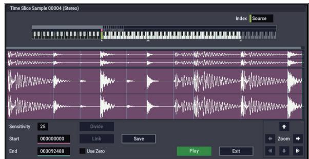
Das vollständige Sample (Source) ist der Taste C2 zugeordnet. Die Einzel-Samples werden dem D2 und den nachfolgenden Noten zugeordnet.
