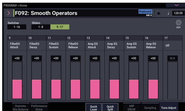
Fader 13 ist „**Amp EG Attack**“ zugeordnet, Fader 14 fungiert als „**Amp EG Decay**“ und Fader 16 kümmert sich um „**Amp EG Release**“.
