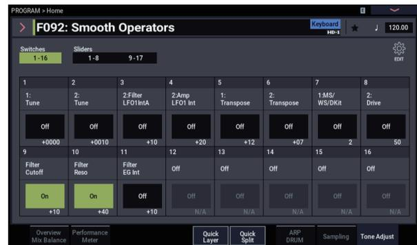
Damit kann man „**Filter Cutoff**“ beziehungsweise „**Filter Resonance**“ anheben. Die Buttons kennen nur den Ein-/Aus-Zustand, wobei sich aber der Wert des „On“-Zustands einstellen lässt (siehe „+10“ und „+40“ in den Wertfeldern der Buttons).
