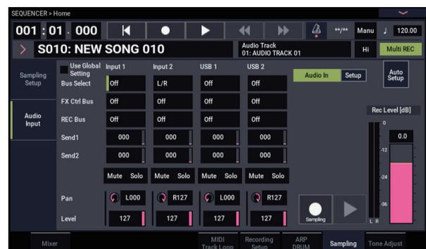
Wählen Sie mit „REC Source“ (Seite „Home– Mixer Audio Track“) Audio-Eingang 1 aus (In 1), damit das Signal von Audio-Eingang 1 direkt auf Audiospur 1 aufgenommen wird.
