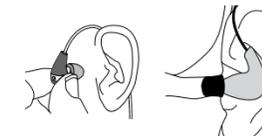
**Wichtig:** Falls es an tiefen Frequenzen (Bass) zu mangeln scheint, bedeutet dies, dass durch die Ohrhörer keine dichte Abdämmung des Gehörgangs erreicht wurde. Den Ohrhörer behutsam tiefer in den Gehörgang drücken oder eine andere Muffe ausprobieren.
