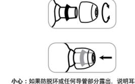
**小心:** 如果防环或任何管部分露出，说明耳塞套安装不正确。如果耳塞套没有将导管罩住，则应更换耳塞套。为确保配合紧密，以获得最佳性能，只能使用 Shure 提供的耳塞套 (除非使用定制的模压耳塞套)。
