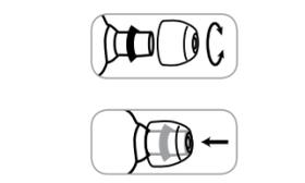
**注意:** 抜け止め部またはノズルの一部が見える場合、イヤパッドは正しく取り付けられていません。ノズルにしっかりと取付できない場合は、イヤパッドを取り替えてください。最適な装着感と性能を得るためには、Shure社製のイヤパッドのみを使用してください (カスタム成形したイヤパッドを使用する場合は除く)。
