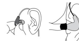
**Importante:** se avete l'impressione che la risposta alle basse frequenze (toni bassi) sia scadente, la tenuta dell'inserto dell'auricolare non è corretta. Spingete delicatamente gli auricolari più a fondo nel canale uditivo o provate con un altro inserto.
