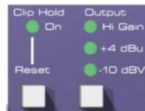
**Hi Gain / +4 dBu / -10 dBV:** Bestimmt den Referenzpegel der Line Level Outputs, der einer Vollaussteuerung des AD-Wandlers entspricht. Siehe Kapitel 10.2.
