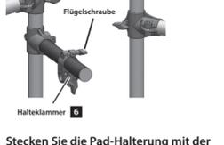
6-4. Stecken Sie die Pad-Halterung mit der Auflage in die Halteklammer und ziehen Sie diese mit der Flügelschraube fest.
