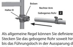
Als allgemeine Regel können Sie definieren: Stecken Sie das gebogene Rohr soweit hinein, bis das Führungslot in der Aussparung der Halterung zu sehen ist. Ziehen Sie dann den Bolzen mit dem Stimmstichsel fest.
