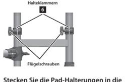
6-2. Stecken Sie die Pad-Halterungen in die Halteklammer und ziehen Sie diese mit den Flügelschrauben fest.
