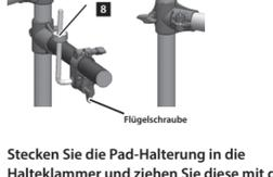
6-5. Stecken Sie die Pad-Halterung in die Halteklammer und ziehen Sie diese mit der Flügelschraube fest.
