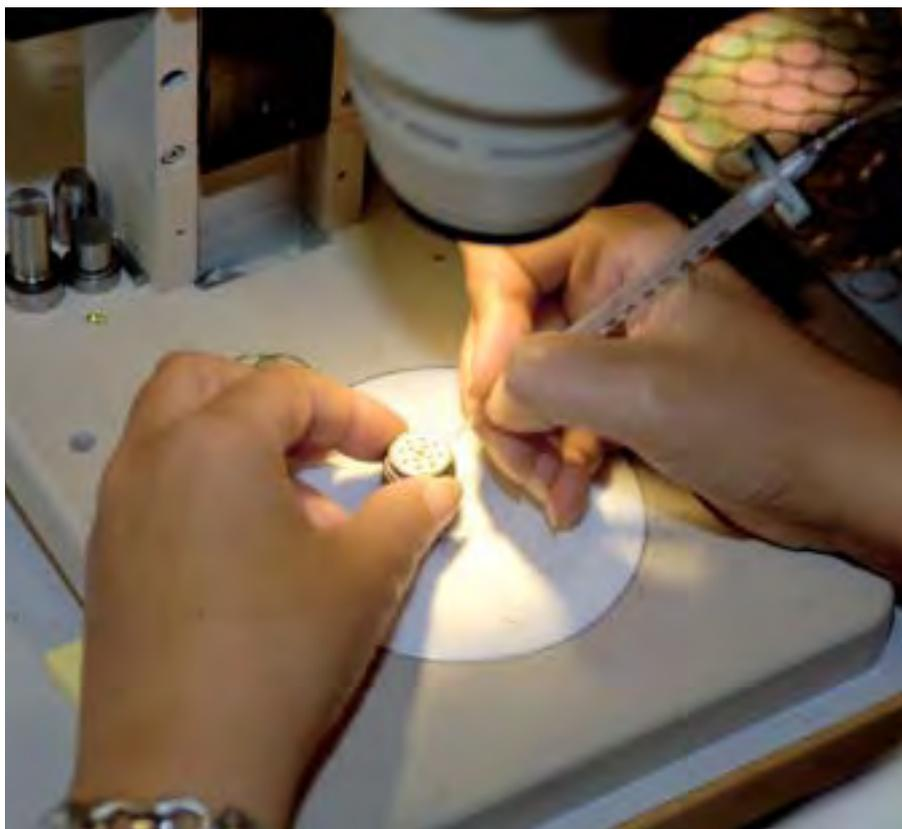
Hier wird eine Kapsel für ein Mikrofon der 4000-Serie montiert. Ohne Mikroskop geht da nichts.
