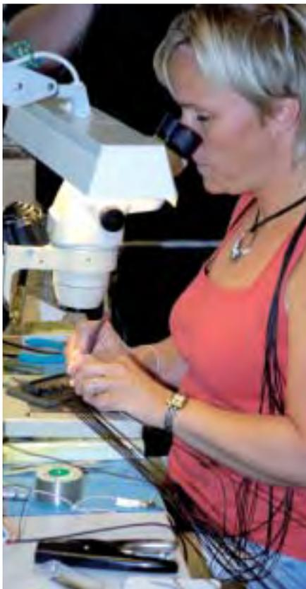
Höchste Konzentration erfordert das Verlöten der Anschlusskabel der Miniatur-Mikrofone.
