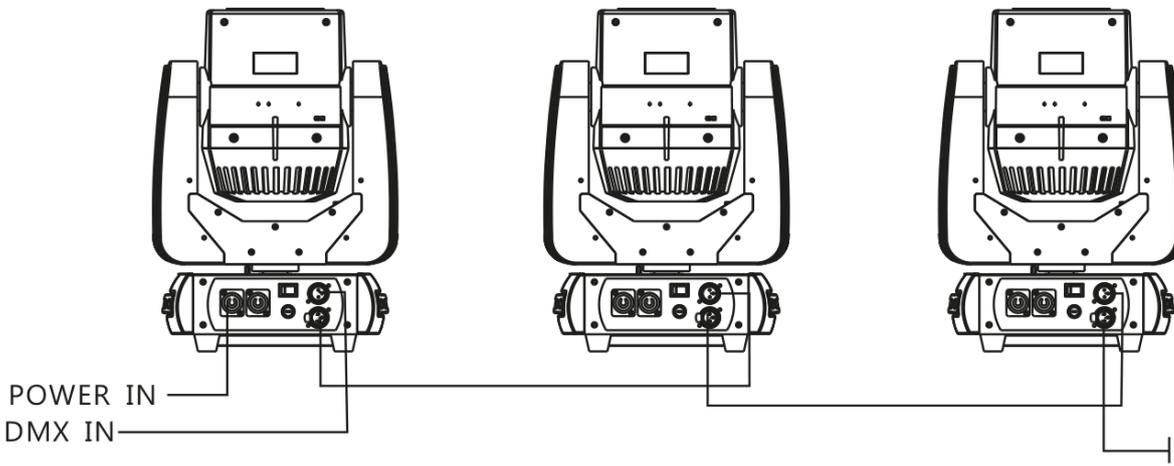
Für Anlagen mit sehr langen DMX-Kabelwegen oder hohen elektrischen Störeinflüssen, wie zum Beispiel in einer Diskothek, ist es empfehlenswert, einen DMX-Terminator zu verwenden. Der DMX-Abschlusswiderstand wird in einem XLR-Stecker als 120  $\Omega$  Widerstand zwischen Pin 2 und 3 ausgeführt der in die letzte Ausgangsbuchse der DMX-Linie gesteckt wird.
