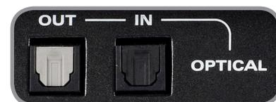
Im ADAT Modus bietet sich die Möglichkeit, die Anzahl der Aufnahmekanäle mit einem zusätzlichen audient ASPO08™ auf 10 zu erweitern. Die ADAT Ausgänge kann man auch an Kopfhörer-Verteilersysteme wie einen Hearback™ HUB oder an einen 8-kanaligen DAC zum Summieren anschließen. Wir haben das iD22 bewusst so gestaltet, dass Sie es entsprechend Ihrer Bedürfnisse erweitern können.
