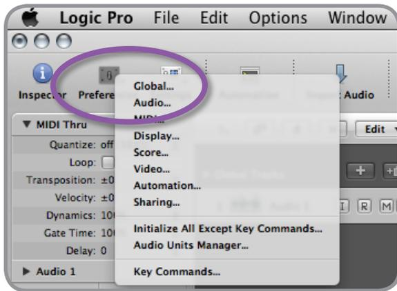
Stellen Sie sicher, dass das iD22 als Audio-Interface aktiviert ist. Hier können Sie Buffergrößen festlegen, um die Systemlatenz zu beeinflussen. Falls Sie Probleme mit der Playback Stabilität und der CPU-Auslastung haben, versuchen Sie die Buffergröße auf > 256 Samples zu erhöhen.
